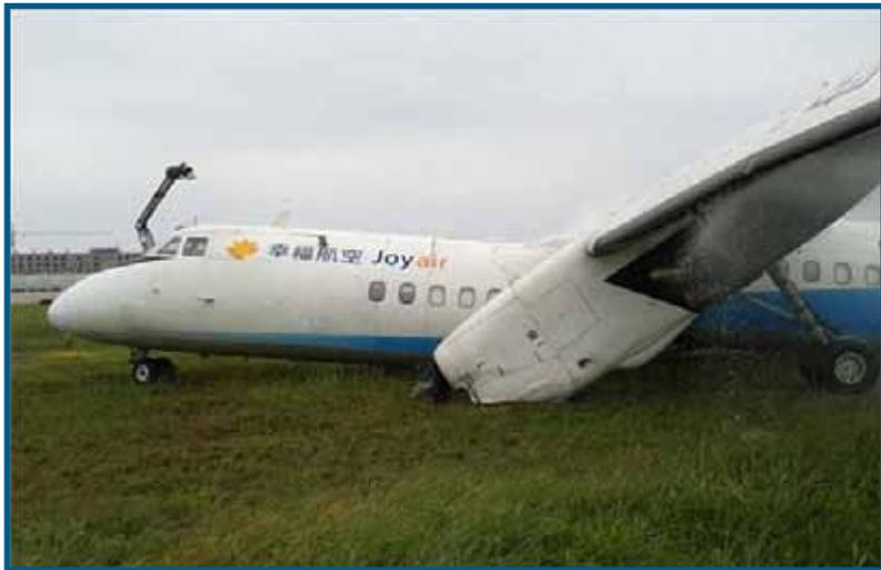
另据民航局组织召开的紧急安全视频会上的意见，此次冲出跑道的主要原因是机组违规操作，在 28 英尺机组错将推力手柄收至到“地面慢车位”，而新舟 60 飞行机组操作手册绝对禁止在空中将推力手柄收到“地面慢车”位置。同时局方也指出，此次冲出跑道事件，也反映出幸福航空安全管理存在缺陷。
